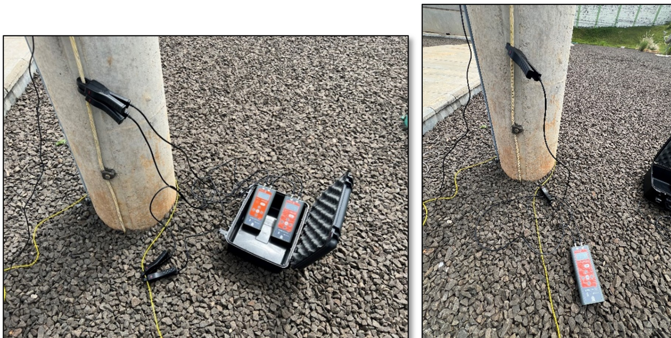
Figura 8 – Medição da corrente de compensação, SE Limeira-06.
